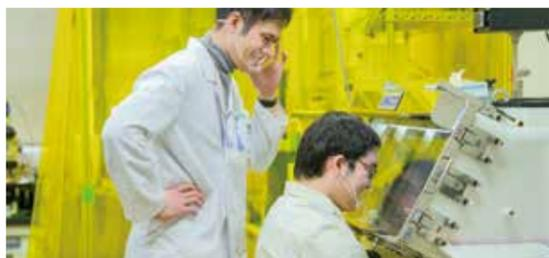
東京都立大学の実験室。JKAの支援で導入された「グローブボックス」という機器。中は窒素ガスが充滿していて、空気中では壊れる物質も扱える
