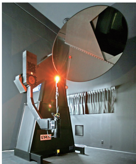
大型配光測定システム。 光源の光をミラーで反射し、 約20メートル離れた受光部で計測する
