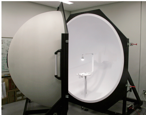
全光束測定システム。 二つに割れるように開く球の中心に 照明器具をセットし、計測する
