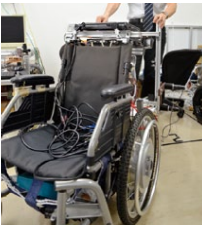
上:歩行誘導機の試作機に脚をつなぐ 下:車椅子を押して歩くと、 脚の動きを機械がサポートしてくれる
