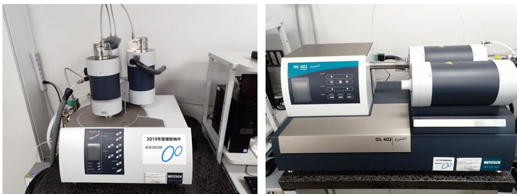
熱特性評価装置（水平型熱膨張計部（左）及び熱機械分析部（右））
