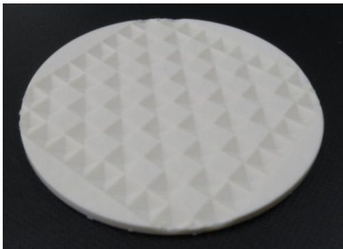
試作品の一例：バルカナイズドファイバー（紙由来の高強度材料）のNC切削加工品
