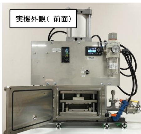
<改修後の拡散接合装置>
