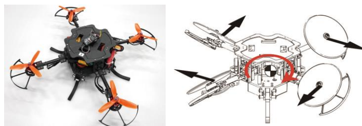
図 2 推力方向可変ベクトル UAV の外観図
