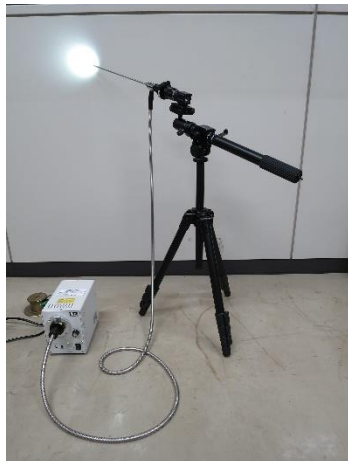
左：検討で使用したボアスコープとハイスピードカメラ、右：ボアスコープの観察像
