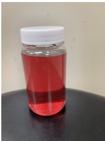
得られた金ナノ粒子分散液。ロッドから均一分散した金ナノ粒子が得られている。
