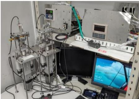
図5 疲労試験装置(1号機(右)と2号機(左))
