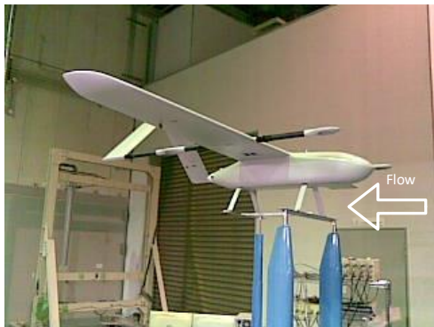
図7 VTOL機の風洞実験
