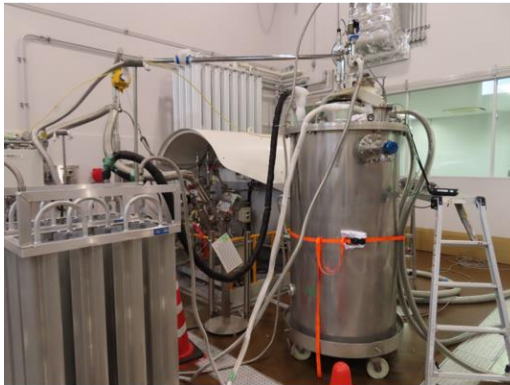
図6 液体水素試験の外観と 50A/sec, 600A の連続励磁試験の結果
