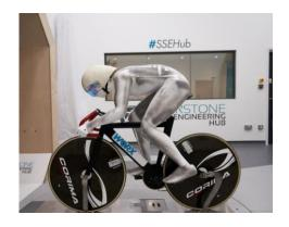
CFDによる検証で良い結果となった形状、数パターンのサンプルを製作し風洞実験で実際の性能を確認。マネキンでの風洞実験にて更に形状パターンを絞り、選手による風洞実験にて最終確認を行った。
