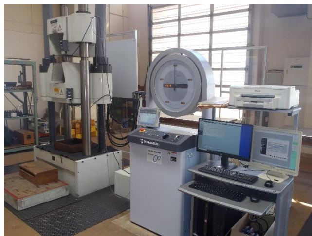
万能材料試験機を含んだ装置全景
