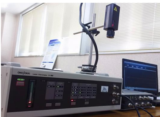
(写真) レーザードップラ式非接触振動計
