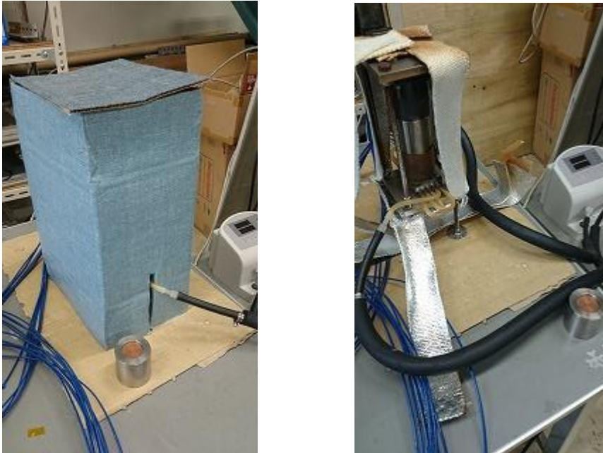
図2 熱輸送量測定装置(左:カバーを外した状態, 右:カバーを付けた状態)
