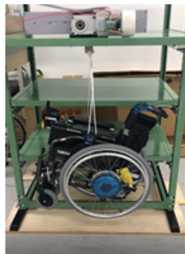
図1 インバータによるモノコックボディ懸架実験
