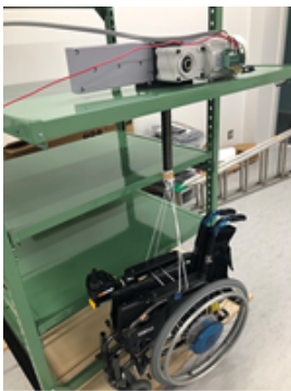
図1 インバータによるモノコックボディ懸架実験
