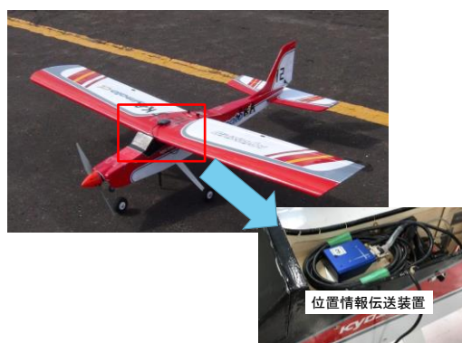
図 4-1 使用模型飛行機と位置情報伝送装置搭載状況
