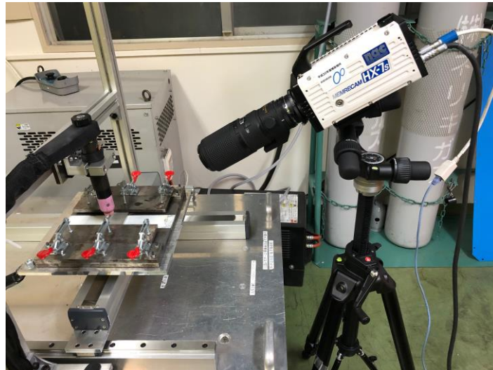
図1 高速ビデオカメラによる溶接現象の観察方法
