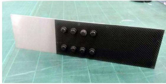
鋼板とCFRP板の締結
