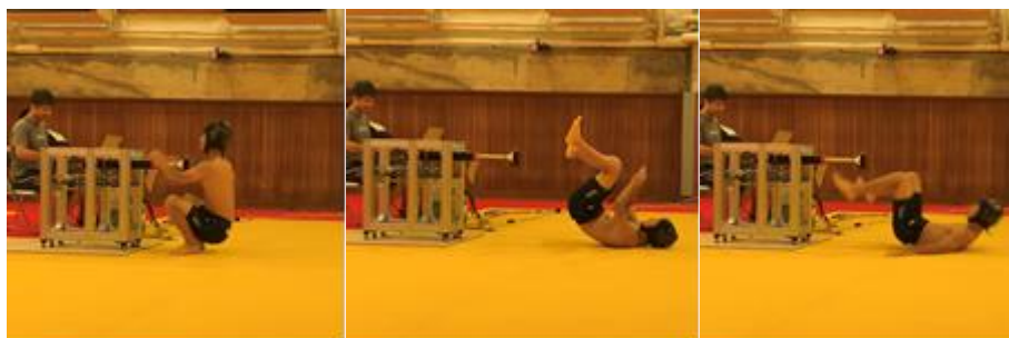
図1 電動アーム装置によって押されて後ろ受け身をする被験者
