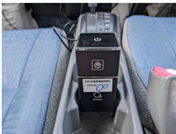
(キャプション：車両内オゾン発生器の設置状況)
