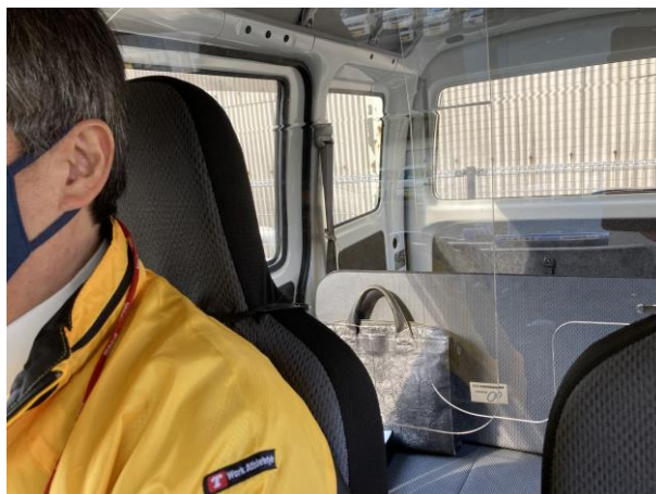
(キャプション：車両内パーテーションの設置状況)
