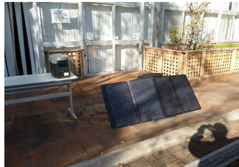
ソーラーパネル付き蓄電池（ソーラーパネルによる充電中）
