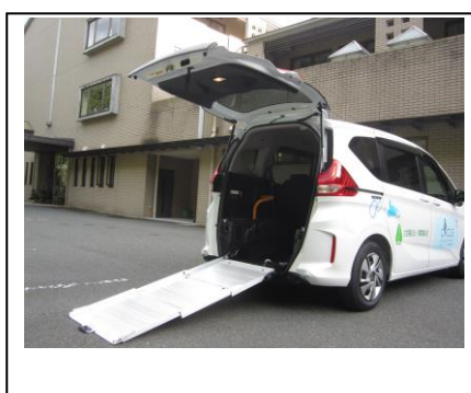
車いすスロープ
